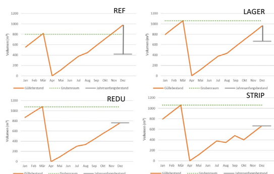
Abbildung 2. Monatlicher Güllebestand und Übermengen (vertikale graue Balken) der vier Szenarien
